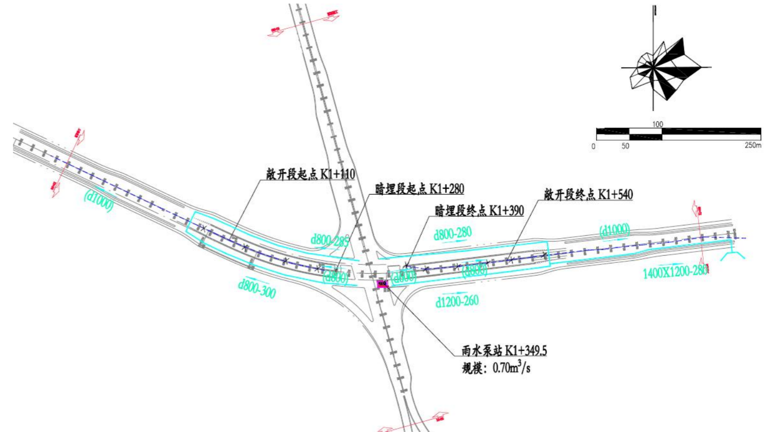
雨水管道系统图
